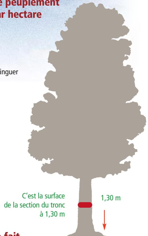
La mesure de la surface terrière à l'hectare se fait grâce à un instrument appelé relascope à chaînette
