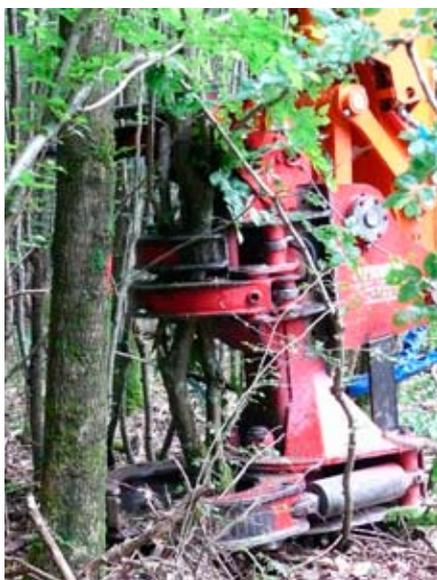
Cisaille montée sur une pelle mécanique.
