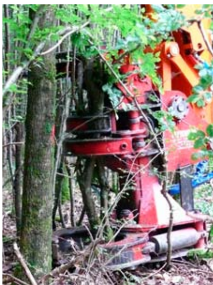
Cisaille montée sur une pelle mécanique.
