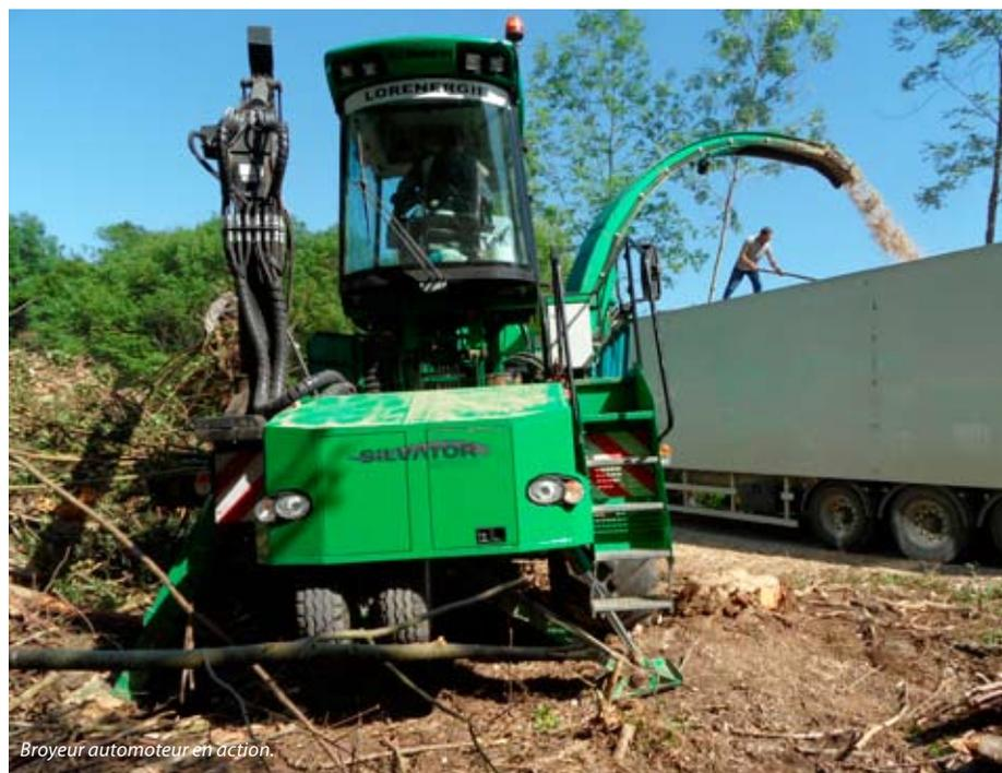
Broyeur automoteur en action.
