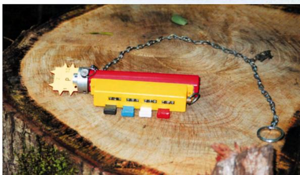
Le complément au relascope à chaînette est un compteur triple ou quadruple (si l'on veut distinguer les TGB des GB) : il permet de mémoriser le nombre d'arbres retenus dans chaque catégorie de bois.
