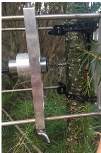
Biocapteur PépiPIAF mesurant la croissance radiale des douglas
