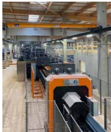
Sur un terrain de 20 ha, vient de voir le jour un ensemble industriel (investissement de 62 millions d'euros) comprenant **une scierie de petits et moyens bois** équipée d'un Canter Hew Sav, **une scierie de gros bois** Primultini, et aussi des séchoirs d'une capacité de 2 000 m<sup>3</sup> alimentés par une chaufferie de 8 MW brûlant des connexes de sciage ; une cogénération de 1,4 MW fournit en électricité l'ensemble, avec la possibilité de revendre l'excédent éventuel.
